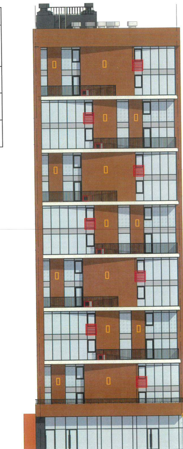
Схема установки кожуха внешнего кондиционера. М 1:80
