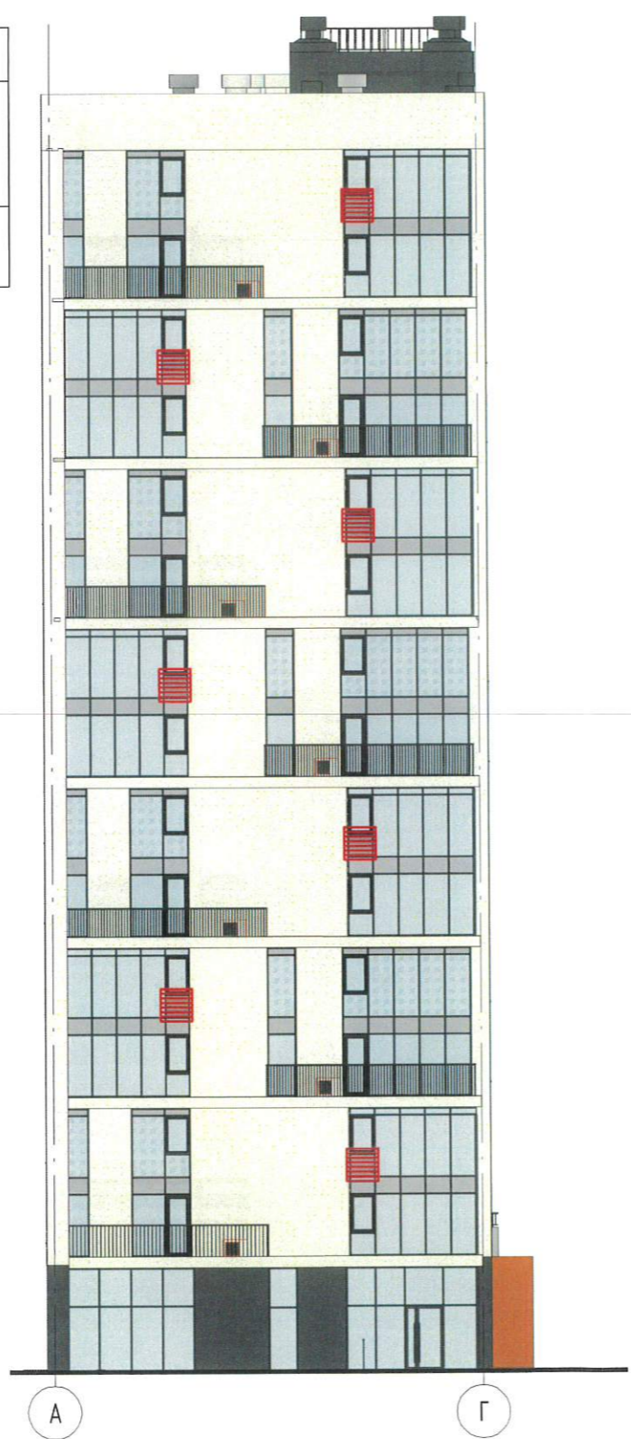
Схема размещения кондиционера на дворовом фасаде в осях А-Г. М 1:250
